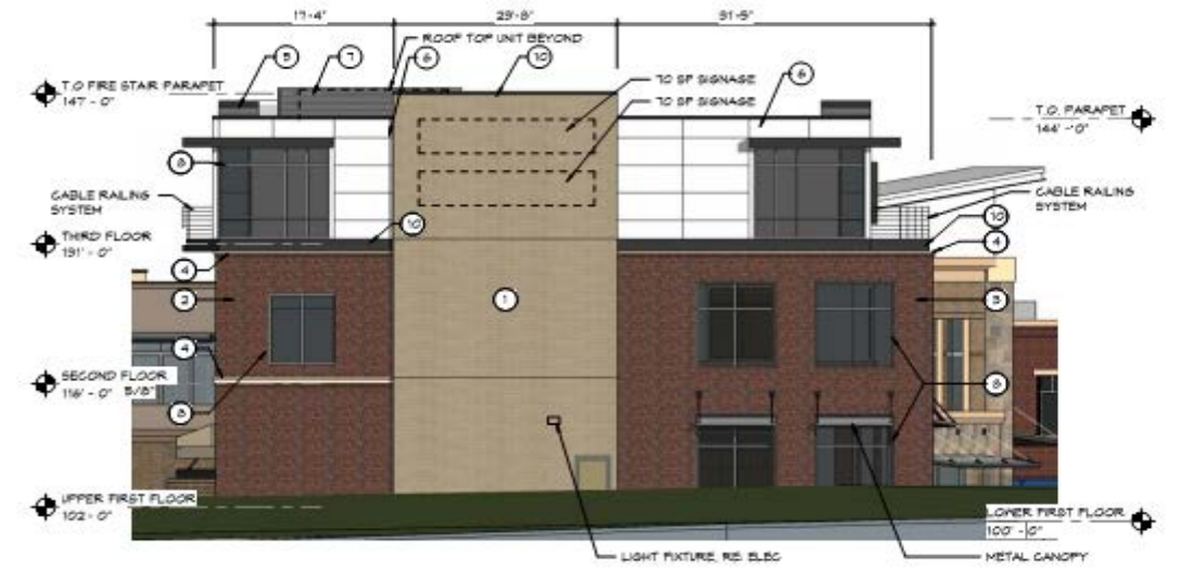
1 SOUTH ELEVATION N.T.S.
