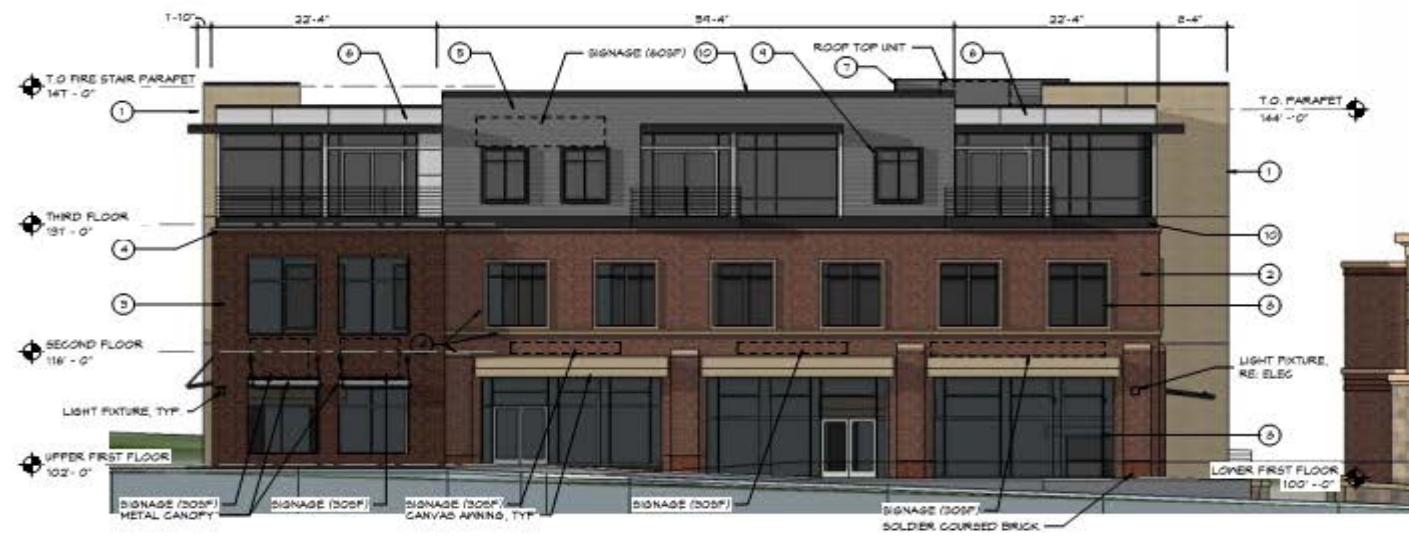
1 EAST ELEVATION N.T.S.
